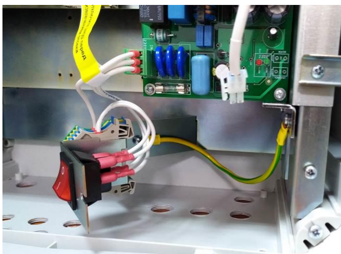
Рисунок 3.5.2 – Узел подключения питания освобожден от крепежа.
