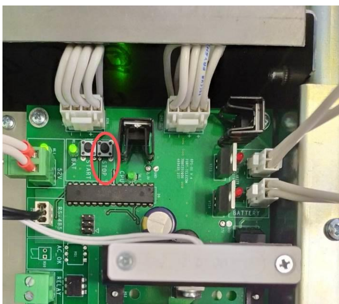
Рисунок 3.5.4 – Нажмите и удерживайте кнопку STOP в течение 5 сек. для отключения питания от АКБ.
