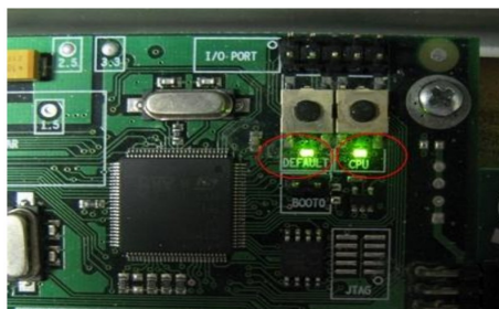
Рис.1.1. Индикаторы DEFAULT и CPU – коммутаторы PSW
