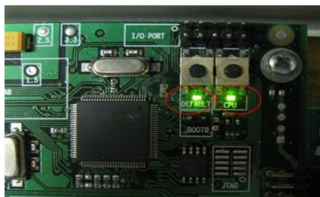
Рис.А.1. Индикаторы DEFAULT и CPU – коммутаторы PSW
