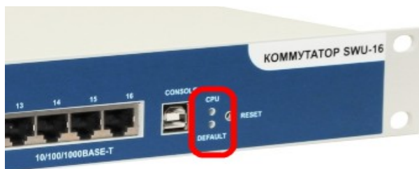
Рис.1.2. Индикаторы DEFAULT и CPU – коммутаторы SWU
