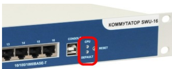
Рис.А.2. Индикаторы DEFAULT и CPU – коммутаторы SWU
